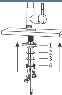
Encaixe o misturador no furo de 35 mm feito no tampo. Conecte os componentes conforme ordem da imagem ao lado: primeiro a arruela de nylon, seguida da vedação em borracha, depois a de metal e por último a porca de fixação. Com o auxílio de uma chave philips de o aperto necessário para fixação do misturador.
