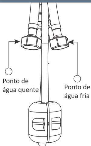
Por fim conecte o flexível vermelho no ponto de água quente e o azul no ponto de água fria. Se a ligação for direto na parede, será necessário o uso de niples que não acompanham o produto.
