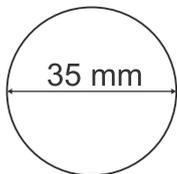
Realize o furo no tampo com o diâmetro de 35 milímetros. A espessura máxima do tampo deve ser de 40 milímetros.
