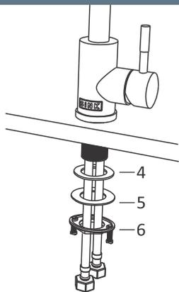
Encaixe o misturador no furo de 35 mm feito no tampo. Conecte os componentes conforme ordem da imagem ao lado: primeiro a arruela de vedação em borracha, depois a de metal e por último a porca de fixação. Com o auxílio de uma chave philips de o aperto necessário para fixação do misturador.
