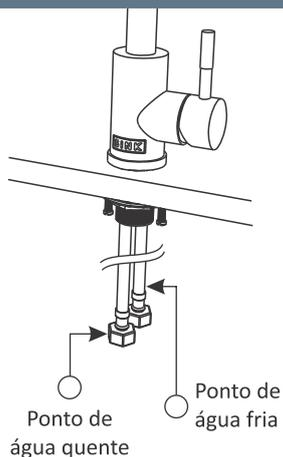
Por fim conecte o flexível vermelho no ponto de água quente e o azul no ponto de água fria. Se a ligação for direto na parede, será necessário o uso de niples que não acompanham o produto.
