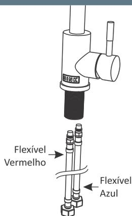
Em seguida conecte os flexíveis ao misturador. Faça este procedimento com as mãos, não é necessário o uso de ferramentas. Cuide para não torcer as mangueiras a ponto de danificá-las.
