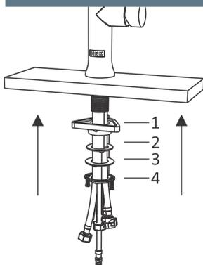
Encaixe o misturador no furo de 35 mm feito no tampo. Conecte os componentes conforme ordem da imagem ao lado: primeiro a arruela de nylon, seguida da vedação em borracha, depois a de metal e por último a porca de fixação. Com o auxílio de uma chave philips de o aperto necessário para fixação do misturador.
