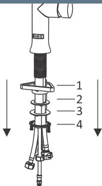
Retire da torneira os componentes que estão fixados nela. Desrosqueie a porca de fixação e depois retire a arruela de fixação, a de borracha e a flange nylon.
