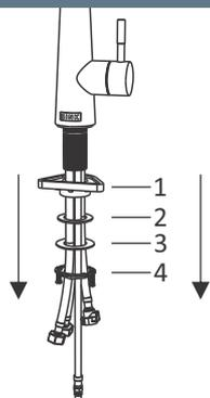
Retire da torneira os componentes que estão fixados nela. Desrosqueie a porca de fixação e depois retire a arruela de fixação, a de borracha e a flange nylon.
